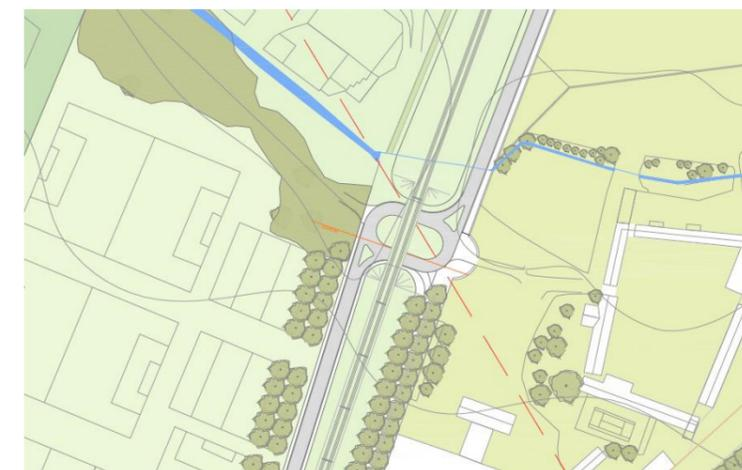
Figure 33 : Carrefour de type ovoïde sous la plateforme de la TGO
